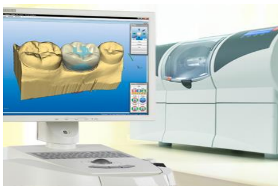
Figure 6 : Logiciel de CAO et machine-outil SIRONA ® [69]
