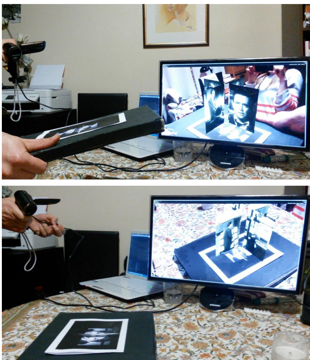
FIGURE 15 – EXPERIENCE DE REALITE VIRTUELLE (SUR LA TABLE S'OBSERVE UNE IMAGE CIBLE, SUR LAQUELLE APPARAÎT UN MODELE 3D DE MON INSTALLATION FOUR WINDOWS QUAND ON LA REGARDE A L'ECRAN).
