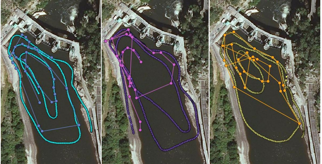
Figure 2 : Trajectoires test : Les trajectoires enregistrées par le GPS sont représentées respectivement en bleu ciel, violet et jaune et les trajectoires calculées par U-Map sont représentées en bleu foncé, rose et orange.
