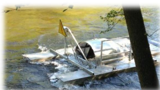
Figure 11: Tambour rotatif à Alleyras (communication interne)
