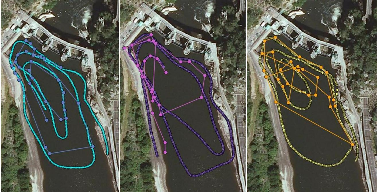
Figure 2 : Trajectoires test : Les trajectoires enregistrées par le GPS sont représentées respectivement en bleu ciel, violet et jaune et les trajectoires calculées par U-Map sont représentées en bleu foncé, rose et orange.
