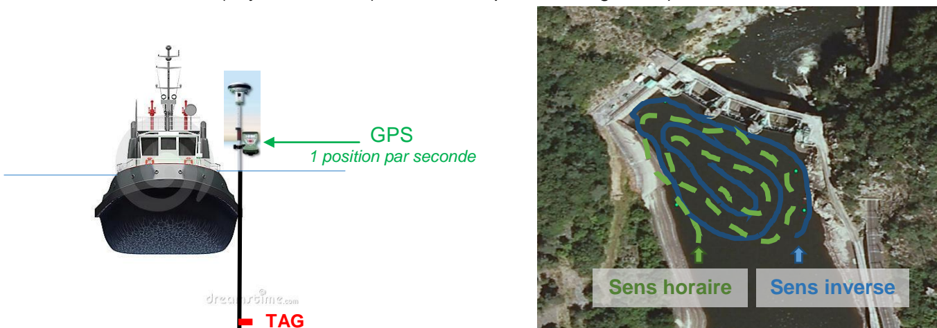
Figure 1 : Réalisation des trajectoires test : (a) Montage de l'émetteur test ; (b) Description des trajectoires réalisées
