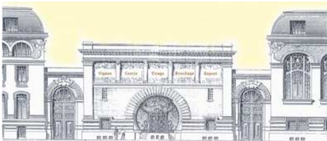
Figure 6: En 1898, la maison Mumm fait construire des celliers et bureaux ; la porte et entourée de briques de verre Falconnier frappées d'un aigle (marque de la maison).
