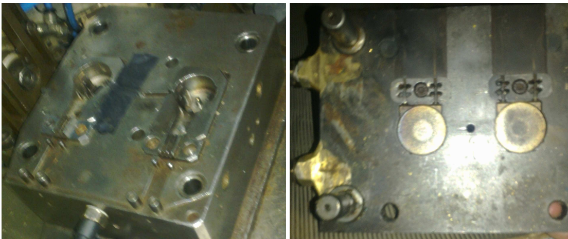
Figure 2-2 : Images des écarts sur les moules
