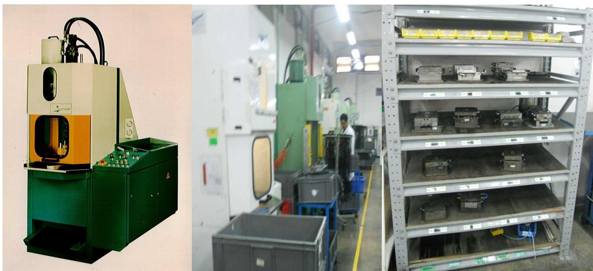
Figure 1-2 : ligne de production de surmoulage (machines, moules...)
