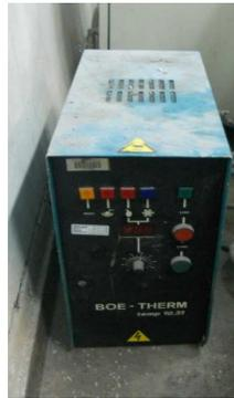
Figure 1-14 : Régulateur de température de moule
