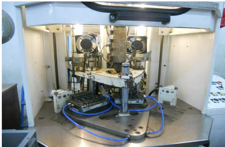
Figure 3-5 : Position des ventilateurs dans la machine.
