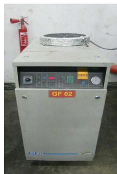
Figure 1-15 : Groupe de refroidissement de la machine
