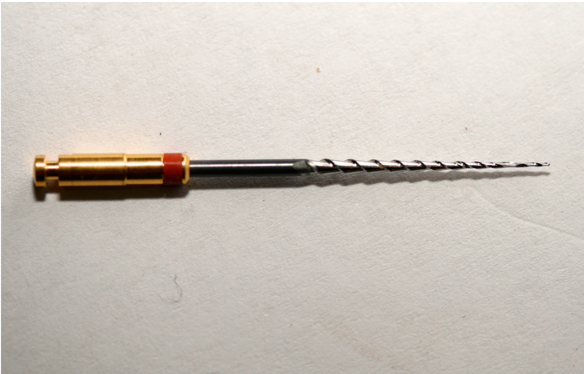
Photo d'ensemble d'un instrument One Shape®, ayant subi une déformation permanente lors de la préparation canalaire.
