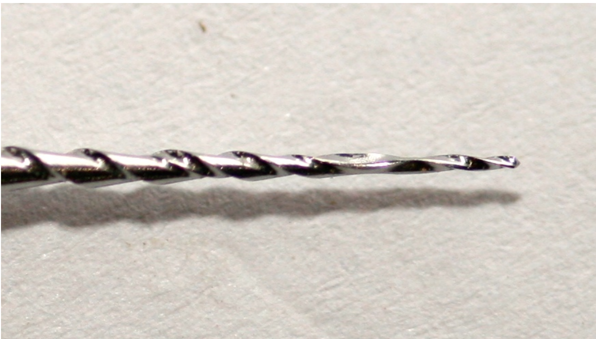
Vue de la déformation permanente subie par cet instrument One Shape®.
