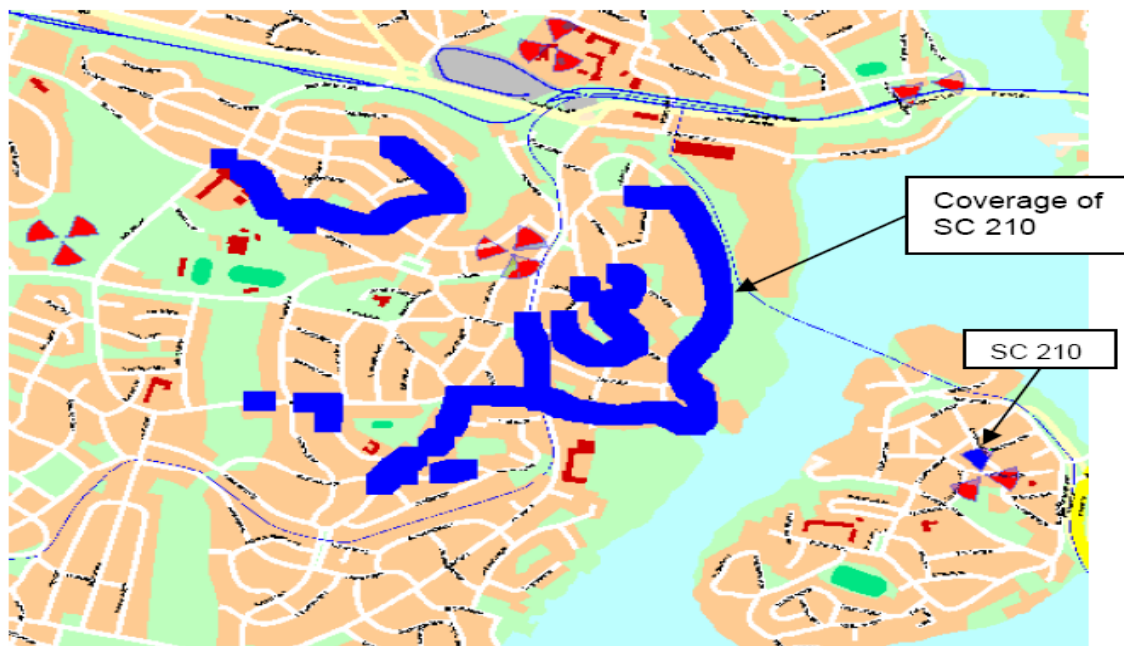
Figure 5-10 Exemple de Overchooting cell pour le SC 210
