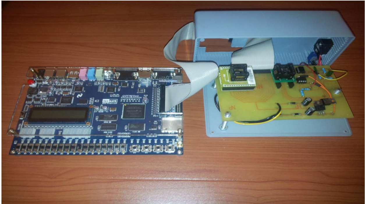
Figure 67: La carte DE2 avec la maquette ou les tests auront lieu.
