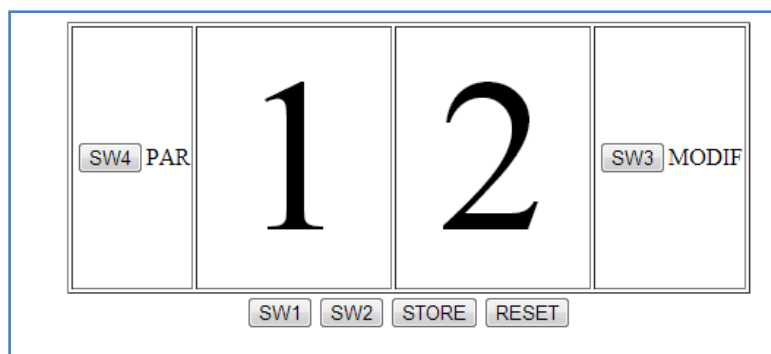
Fig.4.5 : Interface de contrôle et de surveillance de l'ascenseur.
