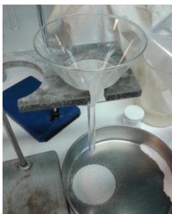
Figure 31 : Test d'aptitude à l'écoulement pour la formulation deux
