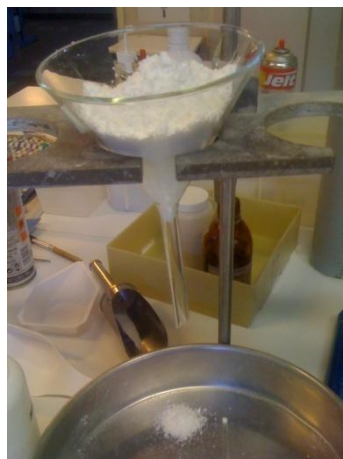
Figure 30 : Test d'aptitude à l'écoulement pour la formulation de l'expérimentation 1
