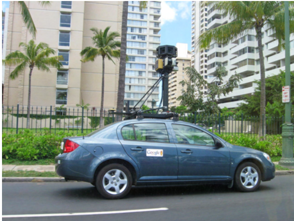
Figure 26 : Exemple de mobile mapping, ici par Google Street View (Source : http://en.wikipedia.org/wiki/Mobile_mapping )
