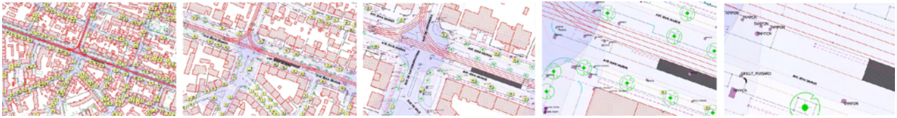
Figure 30 : Exemple de plan corps de rue simplifié de Strasbourg, de gauche à droite au 1/2000e, au 1/1000e, au 1/500e, au 1/200e, au 1/100e (Source : CEREMA).
