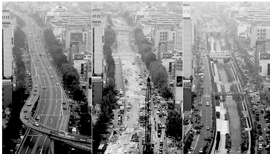
Figure 79. Photos de la rivière Cheonggye, 2003-05, les routes qui couvraient sur la rivière Cheonggye étaient supprimées pour retrouver la rivière au centre ville.
