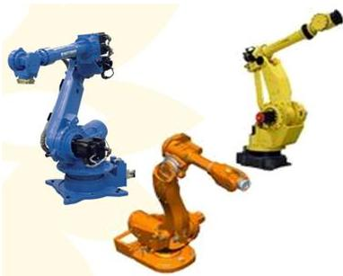
Les robots utilisés ont une capacité de charge comprise entre 120 à 600 Kg et ont un rayon d'action allant de 2,5 à 3,2 m.
