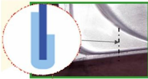
Principe : pincement de tôle (mariage puis rabat de bord) pour réaliser des assemblages de grandes longueurs. C'est une méthode qui permet d'obtenir un assemblage non visible et d'éliminer les arêtes tranchantes.
