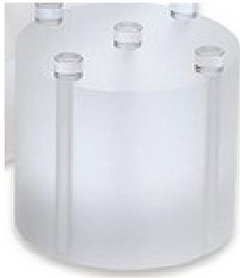
*Figure 7 : Fantôme PMMA de 16cm de diamètre d'après <http://www.orion-france.com>*
