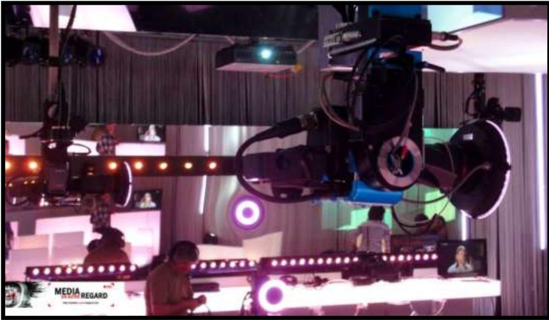
**Figure 34 - Les deux caméras Périscors conçues pour l'émission et évoluant en hauteur sur les rails « pandor » et « junior ».**
