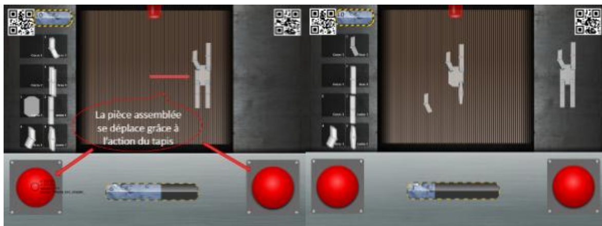
Figure 68. (A gauche) En appuyant sur les deux boutons, le tapis roulant actionné déplace la pièce assemblée dans la zone de sortie. Le joueur peut alors travailler sur un nouvel assemblage (à droite)
