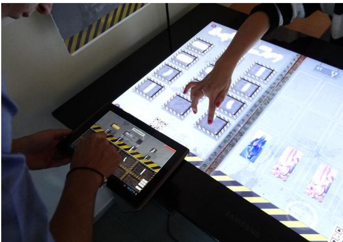
Figure 46. Lors des expérimentations Lea(r)nt, la tablette est contextualisée avec le magasin (table surface). La tablette montre alors les objets que la personne « à table » dépose dans la zone logique commune. Les modalités d'affichage différentes d'une même zone logique, sur la tablette et sur la table surface, sont rendues possibles par le concept de zone numérique.
