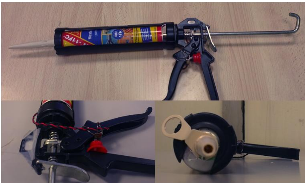
Figure 66. Le pistolet à colle augmenté (en haut), le mécanisme interrupteur (en bas à gauche), la LED « cachée » dans l'embout de collage (en bas à droite).
