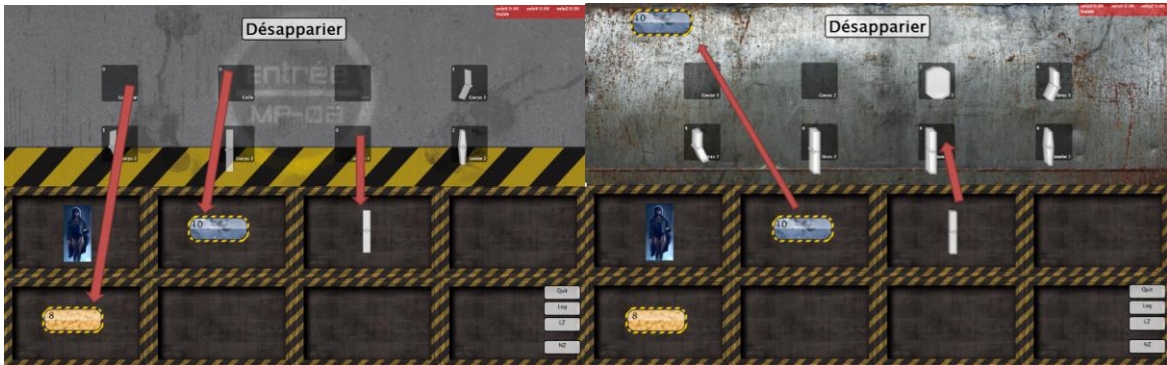
Figure 72. A gauche, la tablette est contextualisée avec la zone du magasin: le manutentionnaire peut prendre des matières premières en les glissant avec le doigt. A droite elle est contextualisée avec la zone d'entrée du poste d'assemblage.
