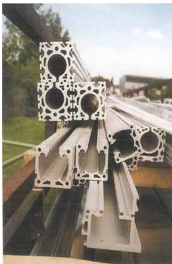
Image 24 : différents types de profilés en alliages d'aluminium
