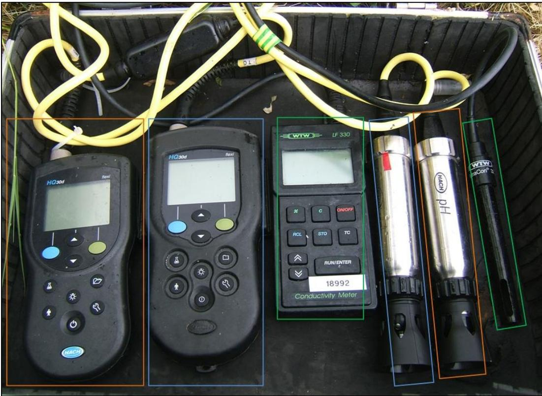
Photographie 1: Sondes utilisées pour la mesure des paramètres physico-chimiques
