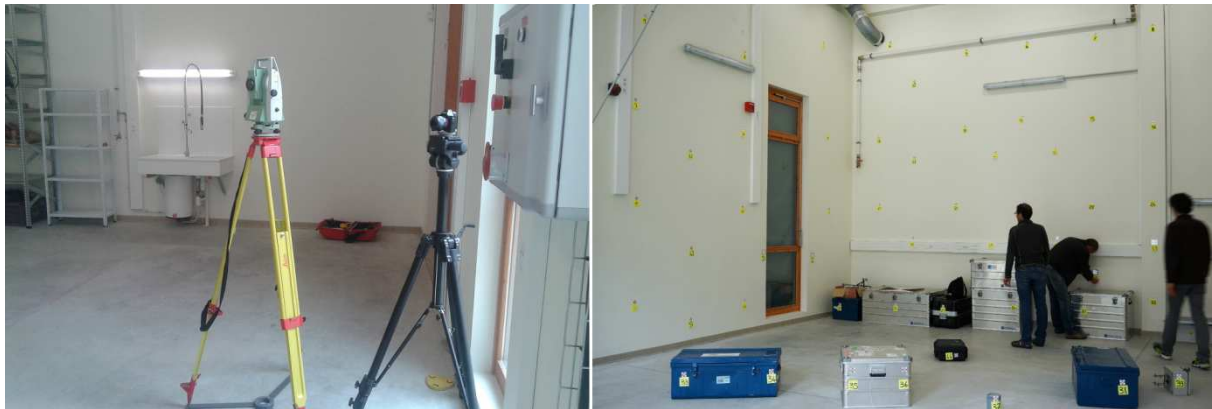
Figure 10 : Mesures de la position de 55 cibles au théodolite pour calculer des paramètres de distorsion de l'objectif 30 cmm Zeiss (P. Lachenal)
