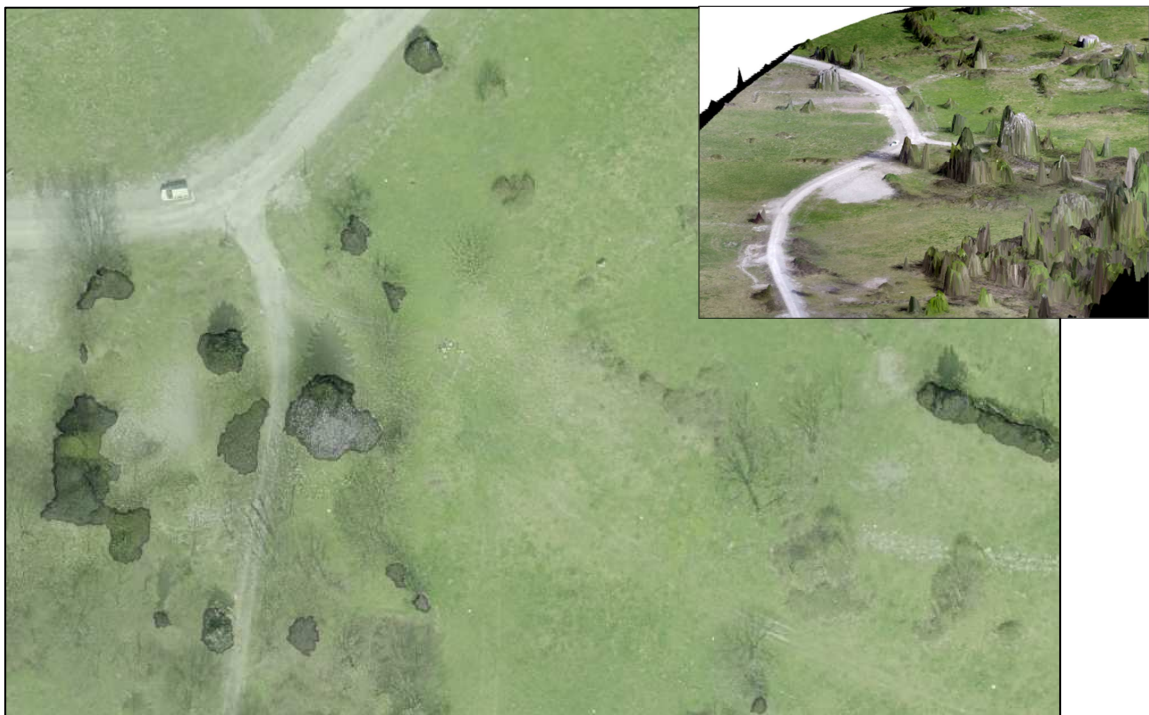
Figure 35: Capture d'écran de l'ortho produite avec Photoscan issue du vol drone d'avril 2015 (encart : modèle numérique de surface drapé de l'ortho sur la même zone)
