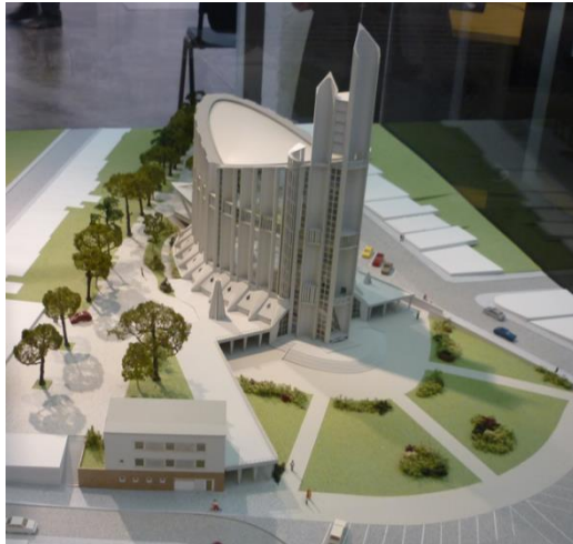
Maquette de Notre-Dame de Royan permettant d'observer la toiture en selle de cheval. Musée de Royan.
