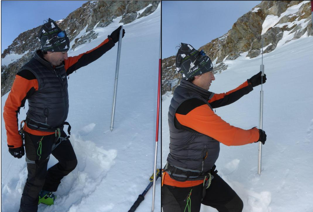
Figure 1.2 : Mesure de sondage par battage, La Grave le 19/03/2015
