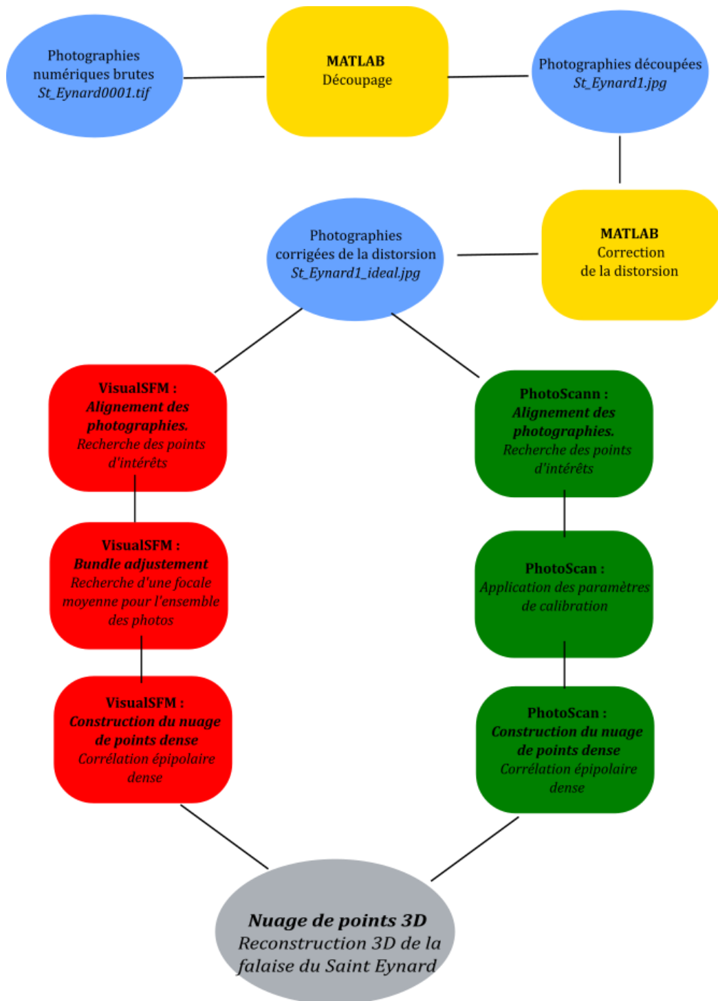
Figure 14: Chaîne de traitement pour la création du nuage de points 3D.
