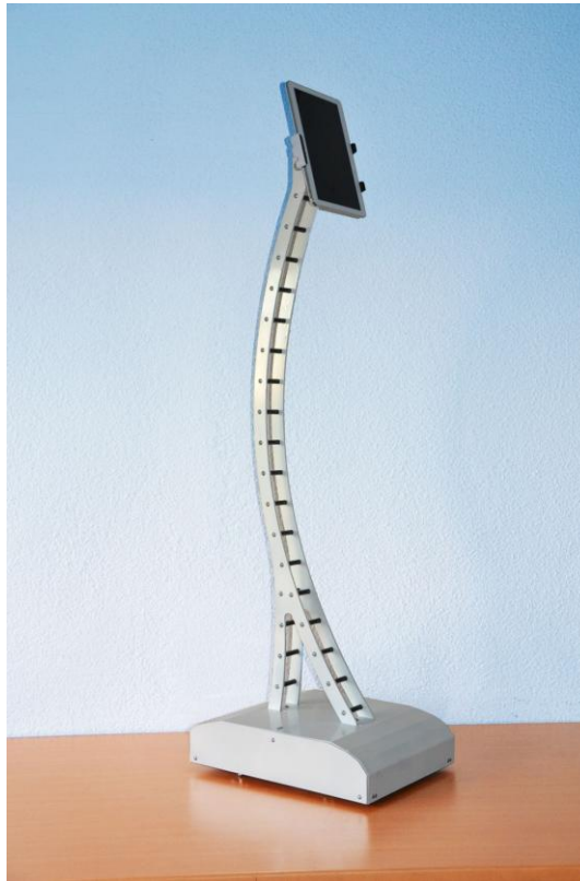
Figure 14 : Prototype de robot de téléprésence évalué
