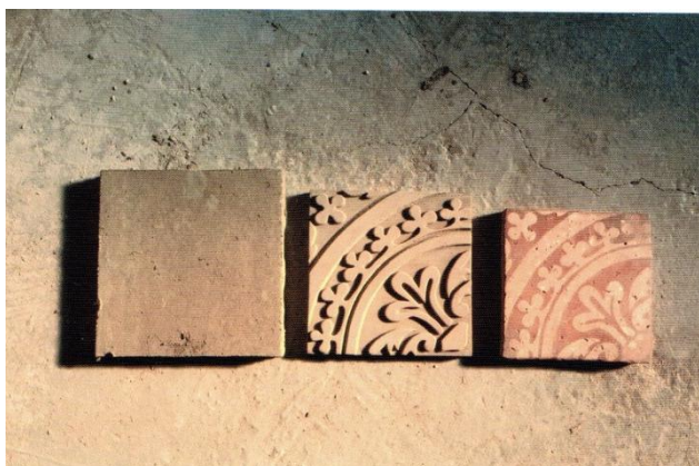
Figure 6 : Soulaines ; le motif créé par la tuilerie ; vues comparées du carreau brut (à gauche) et du carreau estampé et cuit (à droite), en passant par la matrice (au centre), in A. Tridant, Les carreaux de pavement... , 2005.
