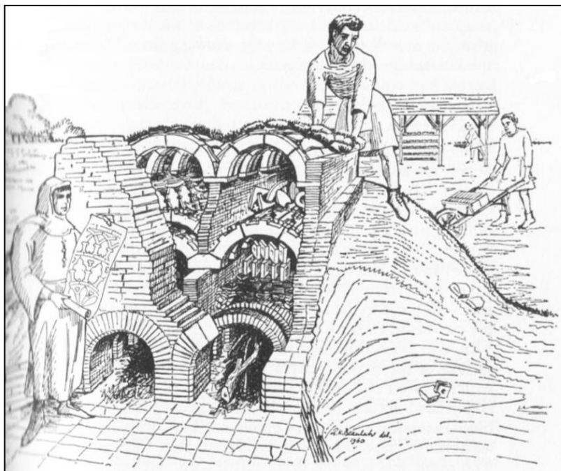
Figure 9 : Reconstitution hypothétique d'un four pour la cuisson des carreaux décorés médiévaux, à partir des données acquises sur les fouilles des sites de Meaux, Chertsey ou Clarendon en Angleterre. d'après E. Eames, 1998 in B. Cicuttini, Productions, techniques de fabrication ... , 2010
