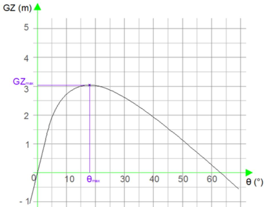
FIGURE 27 – Courbe des bras de levier de redressement
