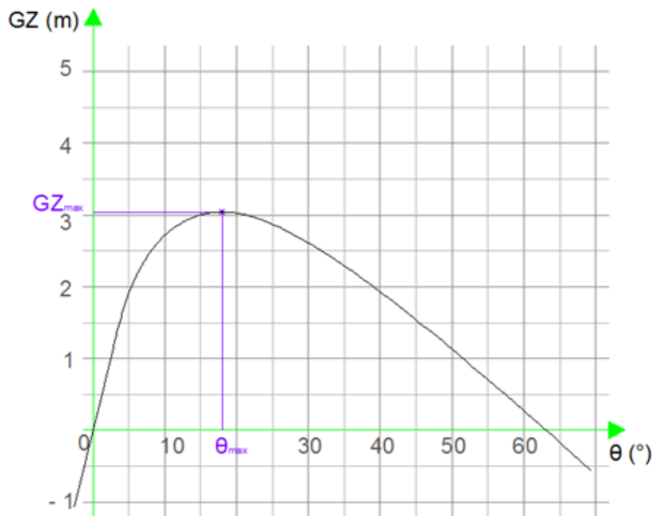
FIGURE 27 – Courbe des bras de levier de redressement
