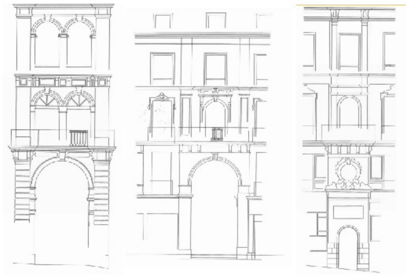
Illustration 5: Relevé photogrammétrique des trois entrées, l'entrée de la galerie Santeuil, de la galerie de la Fosse et de la galerie Régnier. (Source : École Nationale Supérieur d'Architecture de Nantes (ENSAN))
