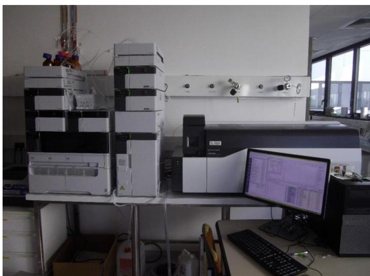
**Figure 10: Système LC-MS/MS utilisé pour les travaux personnels**
