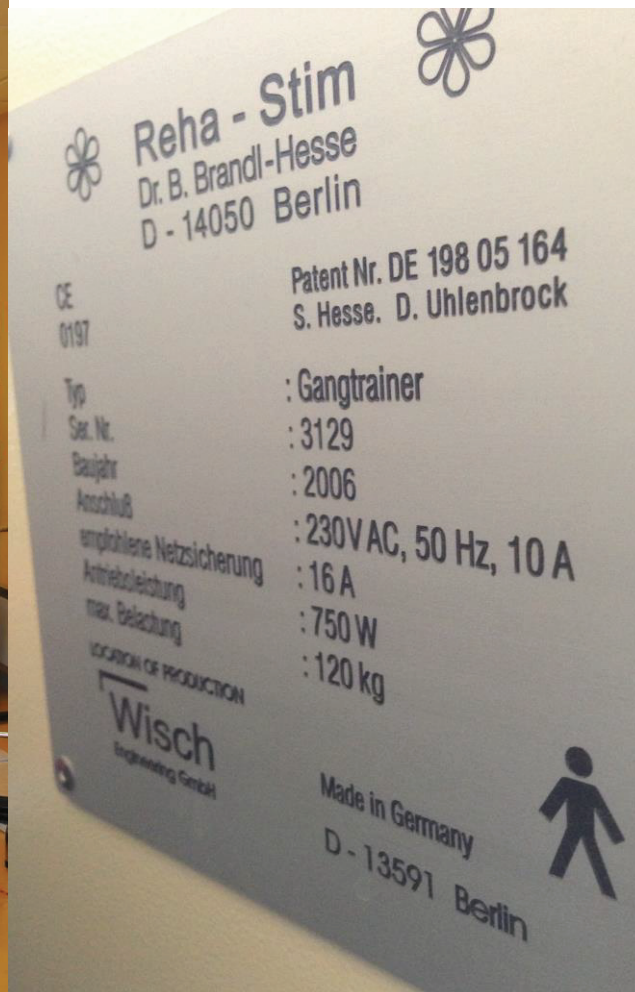
Fig. 9 : Caractéristiques techniques du système Gait Trainer®
