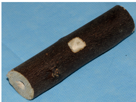
Figure 62 : vue supérieure de la paumelle. Remarquons les deux entailles permettant de placer la poignée verticalement ou horizontalement. Photo B. Cros.
