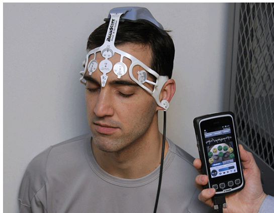
Figure 45 : Casque BrainScope relié à un smartphone (source : forbes.com)
