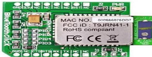
**Fig. III.27. Module Bluetooth RN41**
