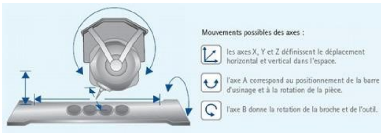
[Figure 24] Exemple de mouvements sur 5 axes sur la machine Everest de Kavo®.
