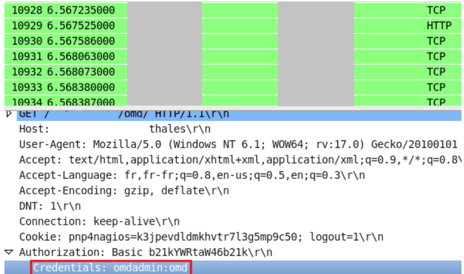
Figure 14 : Capture de trames avec identifiants en clair
