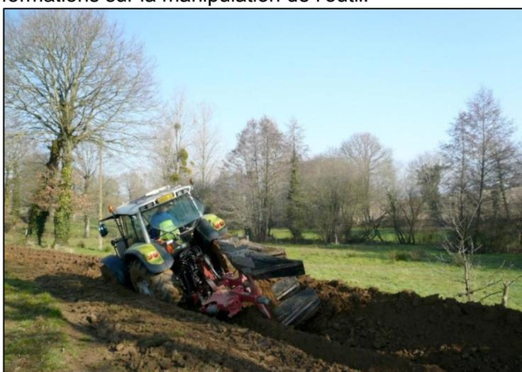
Figure 24 : photographie illustrant le principe de création d'un talus avec une charrue forestière. L'attelage se monte sur un tracteur comme une charrue classique. Plusieurs passages successifs créent une levée de terre de 80 cm de haut et d'un mètre de large. (T. Guehenneuc, Terres & Bocage, 2008)
