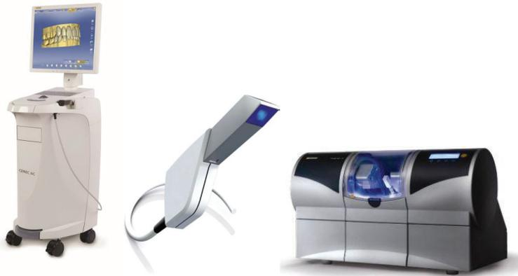
Figure 82. Console de Conception Assisté par Ordinateur CEREC AC (Sirona, 2012) Bluecam (Sirona, 2012) et unité d'usinage MC XL (Sirona, 2012)
