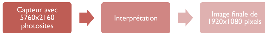
Figure 3 : Schéma du capteur de la Panavision Genesis qui obtient une image finale avec un nombre de photosites supérieur à l'image finale
