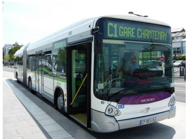
Heuliez GX 427 à motorisation hybride en test sur la ligne Chronobus C1
