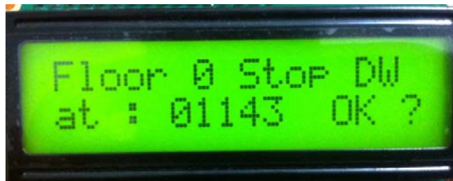
Fig.55 : Mise au point du positionnement de la cabine
