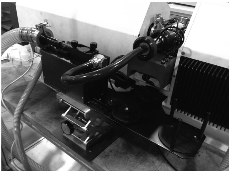
Figure 58 : Module InHaler® - branchement pompe post-chambre de détection
