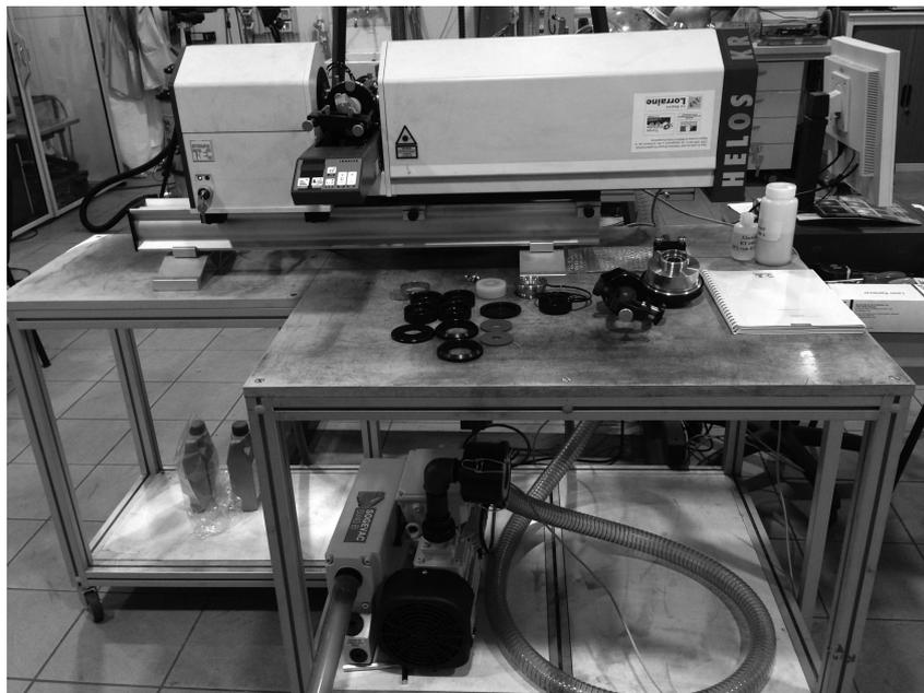
Figure 55 : Montage module InHaler® adapté sur Helos®
