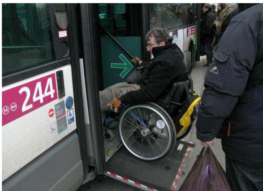
Figure 8 - La palette d'accès aux bus RATP pour les personnes en fauteuil roulant.
