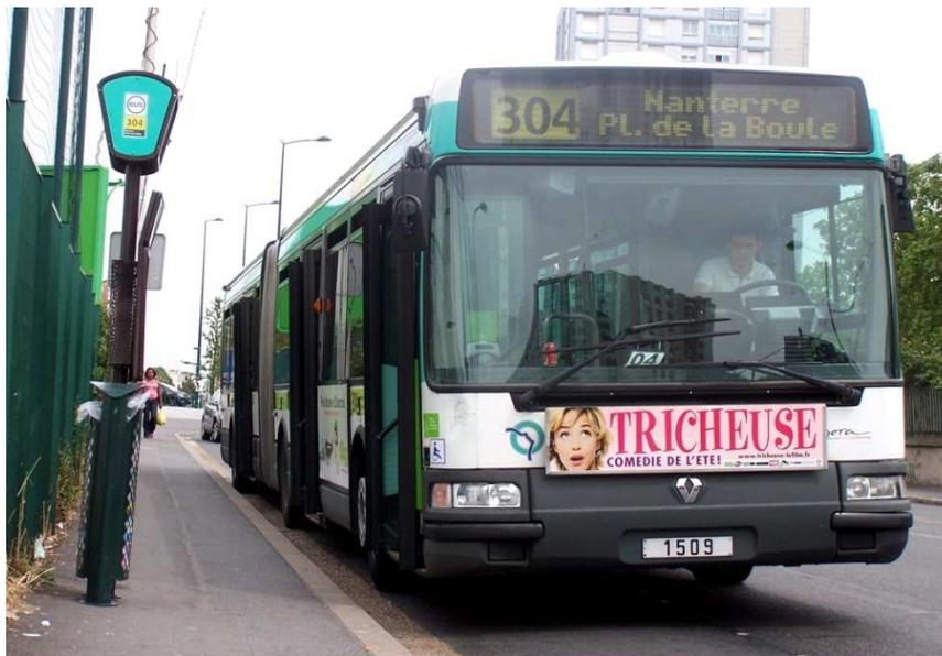
Figure 12 - Bus RATP avec girouette frontale à pastilles.
