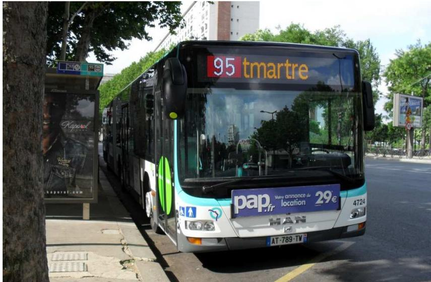
Figure 13 - Bus RATP avec girouette frontale à LED.
