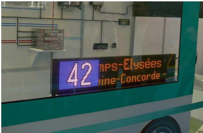
Figure 14 - Girouette latérale à LED des bus RATP.
