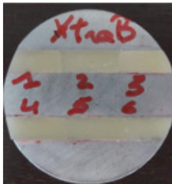
Figure 32: *Polissage des cylindres de composite*
