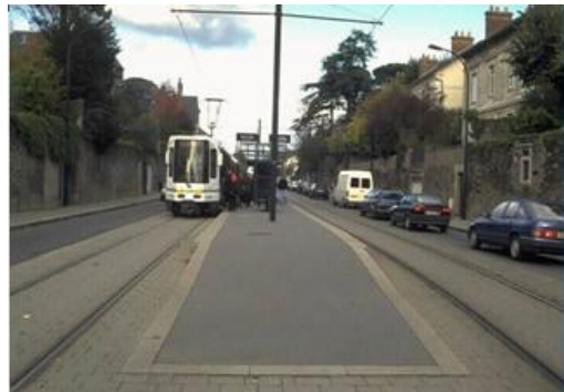
Figure hh : Station à quai central
