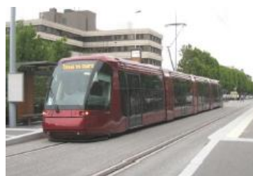
Figure p : Tramway sur pneu avec guidage par rail (Source : Sophie Morhun, La renaissance du tramway )
