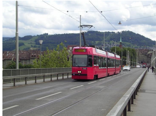
Figure x : Tramway de Berne en site banalisé
