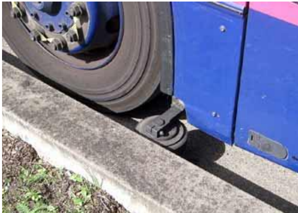
Figure i : Système de guidage "O-Bahn" (Source : http://www.bhns.fr )
